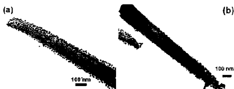
Hình 7. Ảnh TEM của OA-SiNW (a) và VA-SiNW (b) sau khi được lắng đọng các AgNP cùng một lúc trong cùng điều kiện như nhau.
