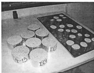
Hình 5. Mẫu thử H = 5\text{cm} , D_1 = 10\text{cm} , D_2 = 5\text{cm}
