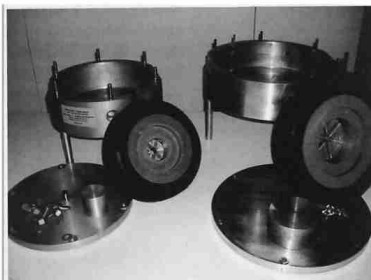
Hình 4. Khoang chứa mẫu đo độ thấm khí: đường kính 5 cm (trái)/đường kính 10 cm (phải)
