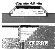
Hình 9a. Thi công nền đắp trên đất yếu Hình 9b. Thi công nền đắp sau móng cầu
