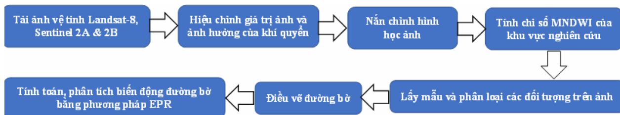
Hình 1. Quy trình tính toán phân tích biến động đường bờ từ ảnh vệ tinh
