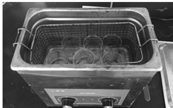
▲ Hình 2. Tẩy trắng thạch anh bằng thiết bị rung siêu âm
