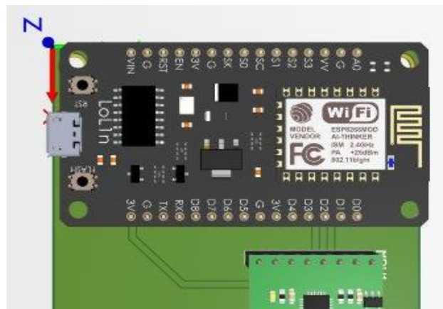
Hình 4. Thiết kế và gia công mạch kết nối hai thiết bị.
