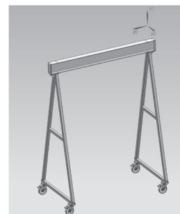
Hình 3.1: Cổng trục đẩy tay tải trọng 1 tấn
