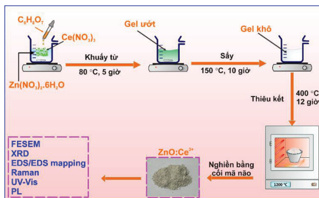
Hình 1. Quy trình chế tạo vật liệu nano \text{Zn}_{1-x}\text{O}:x\text{Ce}^{3+} bằng phương pháp sol-gel.
